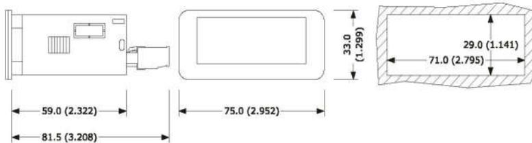
59,0 (2,322) – наибольшая глубина с блоком клемм на винтах; 81,5 (3,208) – наибольшая глубина с быстро съёмными контактными группами.
