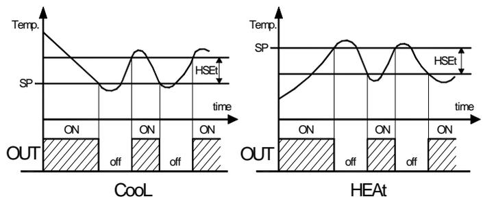
В случае выхода из строя датчика, можно установить прибор так чтобы модуль **"OUT"** продолжал работать в соответствии с запрограммированным временем в параметре **"tonE"** (время активизации) и **"toFE"** (время дезактивизации).
